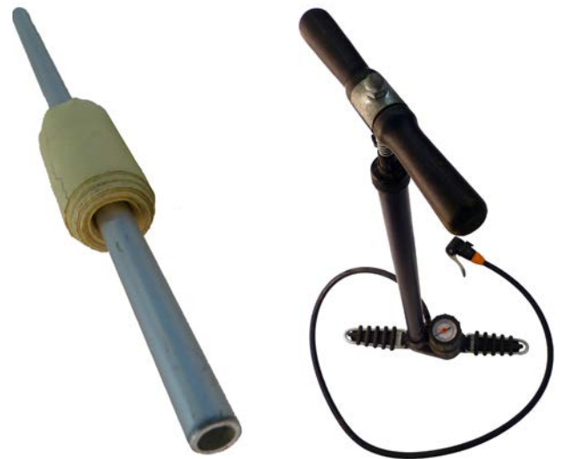
Abb. 252 | Der Zapfen und eine Standpumpe mit Druckanzeige
