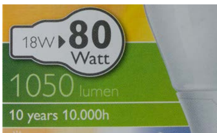
Abb. 263 | Die Angaben auf der Verpackung von Leuchtmitteln beziehen sich auf deren Leistung bzw. auf die Energie, die sie in einer Sekunde konsumieren. Lumen ist ein Mass für die Helligkeit der Lampe.
