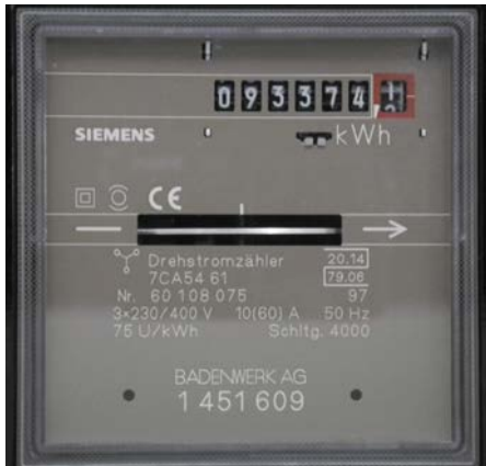
Abb. 262 | Elektrische Energie wird in kWh (Kilowattstunden) gemessen. Kilowattstunden basieren auf Wattsekunden (Ws): 1 \text{ kWh} = 1 \times 1000 \times 1 \text{ W} \times 3600 \text{ s} = 3\,600\,000 \text{ Ws} Kilowattstunden sind praktisch im Alltag, haben aber den Nachteil, dass die hineingerechneten Stunden nicht dezimal sind. Wattsekunden dagegen eignen sich besser für Berechnungen in der Physik, insbesondere wenn verschiedene Einheiten ineinander umgerechnet werden, denn: 1 \text{ Wattsekunde} = 1 \text{ Joule} = 1 \text{ Newtonmeter} oder 1 \text{ Ws} = 1 \text{ J} = 1 \text{ Nm} .
