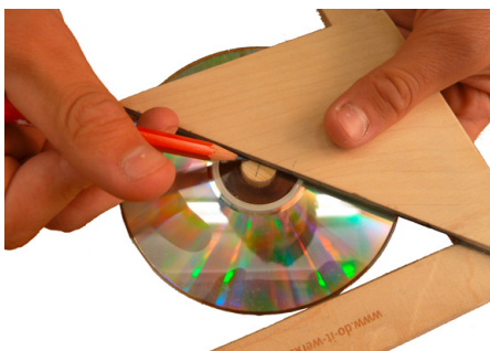
Abb. 158 | Mit dem Zentrierwinkel Mitte bestimmen.
