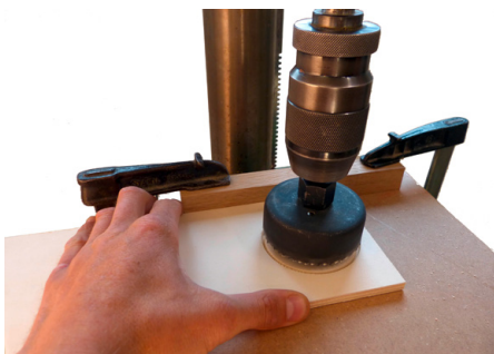
Abb. 157 | Glockensäge nur mit Anschlag benutzen.
