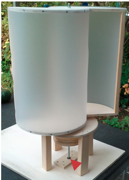
Abb. 274 | Savonius-Windrad mit Feststellschraube
