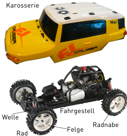
Abb. 178 | Karosserie und Fachbegriffe zum Fahrgestell
