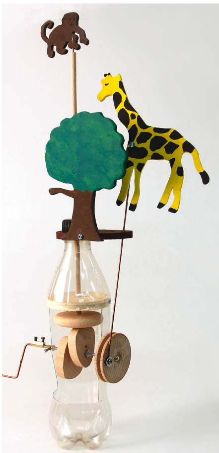
Abb. 217 | Maschine zum Thema mechanisches Theater einer 5.-Klässlerin: Sichtbar sind Maschinenteile wie beim Handmixer, aber auch neue Elemente wie Nocken, Reibrad und Pleuel.
