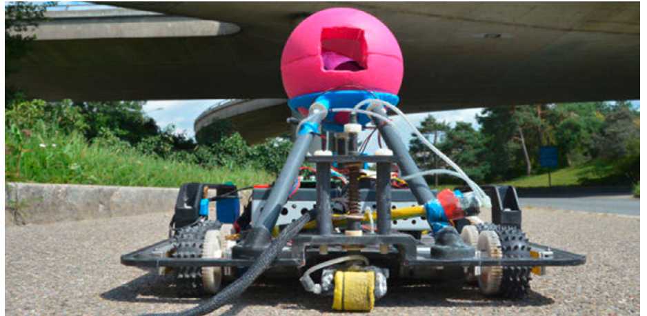
Abb. 28 | Der Roboter C2D2 der ETH Zürich überprüft den Zustand von Bauwerken an für den Menschen schwer zugänglichen Stellen – z. B. kopfüber an der Unterseite einer Brücke.
