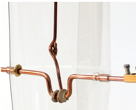
Abb. 202 | Schubstange mit Pleuel, geführt mit Kartonunterlagsscheiben
