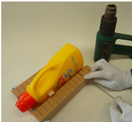
Abb. 189 | Einklemmen des unregelmässigen Behältnisses mit Keilen.
