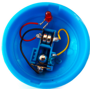
Abb. 139 | Analyse des Fliehkraftschalters eines Leuchtdiodenkreises
