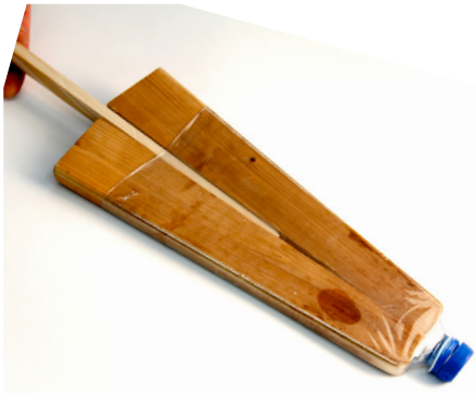
Abb. 268 | Schrumpfform mit Keil zum Spannen
