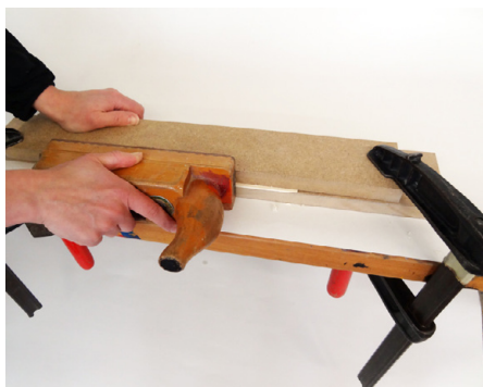
Abb. 168 | Wichtig: Das Furnier und die Platten müssen unten bündig sein.
