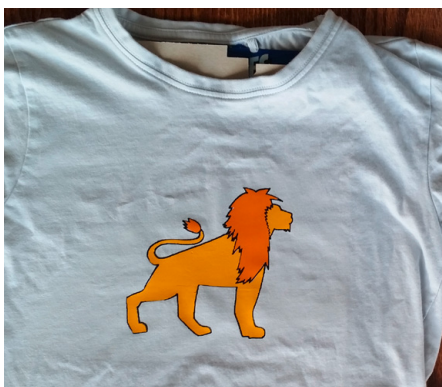
Abb. 63 | Bei mehrteiligen Bildern wird jeder Teil nur kurz angepresst und erst am Schluss, wenn alle Teile an ihrem Platz fixiert sind, wird lange gepresst.
