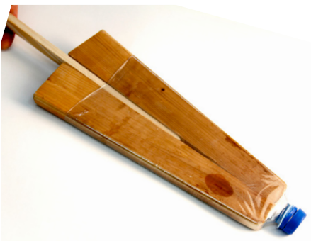
Abb. 283 | Flasche schrumpfen mittels Holzform und Heissluftföhn.
