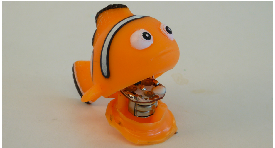
Abb. 19 | Dieses Plastikspielzeug beinhaltet zwei LEDs, benötigt drei Knopfzellen und war beim Verkauf in Plastikfolie eingeschweisst.
