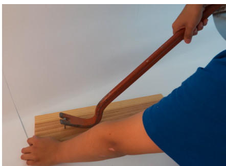
Abb. 221 | Mit dem Geissfuss lassen sich auch grosse Nägel mit wenig Kraft ausziehen.
