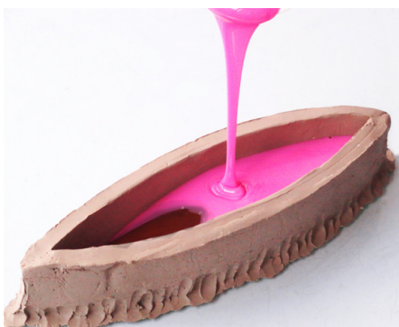
Abb. 42 | Zur Herstellung einer Giessform für Wackelsteine wird Silikonkautschuk um das Modell in die Schalung gefüllt.
