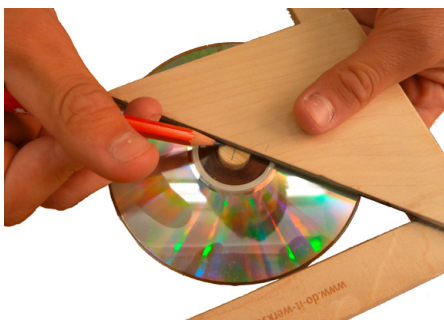
Abb. 158 | Mit dem Zentrierwinkel Mitte bestimmen.
