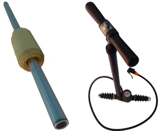
Abb. 252 | Der Zapfen und eine Standpumpe mit Druckanzeige
