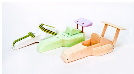
Abb. 175 | Karosserieentwicklungen mit Polystyrol (tiefgezogen), Polystyrolschaumstoff und Sperrholz
