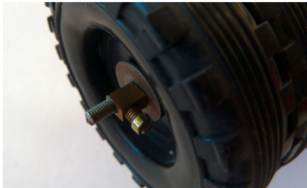
Abb. 205 | Räder auf Achsen lassen sich mit Lüsterklemmen, Reduzierstücken, Gummi- oder Stellringen sichern.
