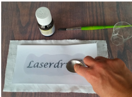
Abb. 51 | Durch Druck wird die Farbe auf den Stoff übertragen. Dass die Übertragung stattgefunden hat, erkennt man, wenn die Vorlage heller wird.
