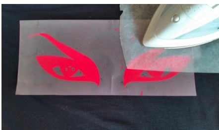
Abb. 58 | Das Motiv Stück für Stück anpressen. Bactrennpapier nicht vergessen.
