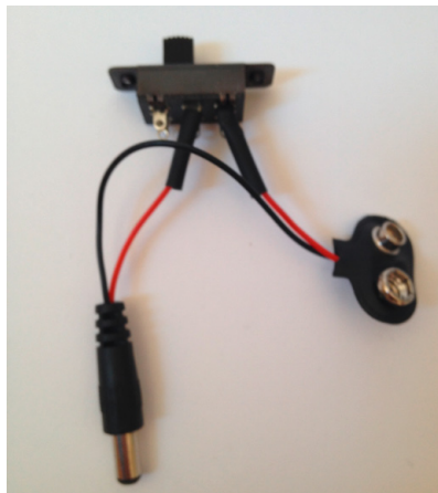
Abb. 304 | Durchgetrennter Batterieclip mit Schrumpfschlauch und Schalter.
