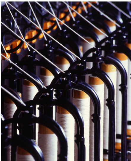
Abb. 273 | Vor dem Ringspinnen wird das Streckband auf der Flügelspinnmaschine (Flyer) zu einem Vorgarn, der Lunte, vorgespinnen.
