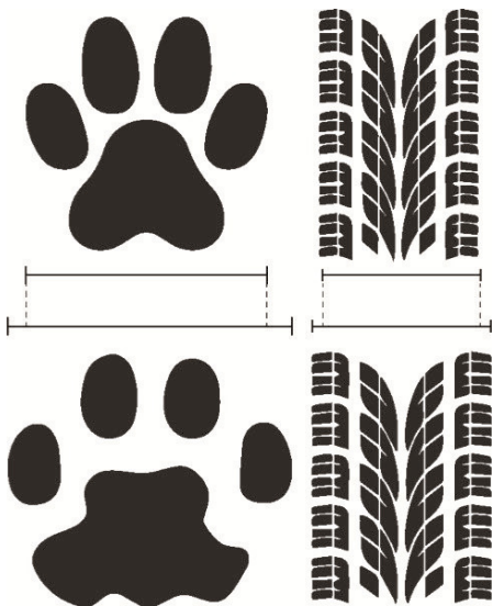
Abb. 126 | Ähnlich wie Katzenpfoten verbreitern sich die Autoreifen beim Abbremsen. Die Bremsfläche wird dadurch vergrößert und der Bremsweg verkürzt.
