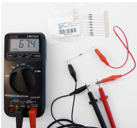
Abb. 137 | Widerstandsmessung an einem Widerstand
