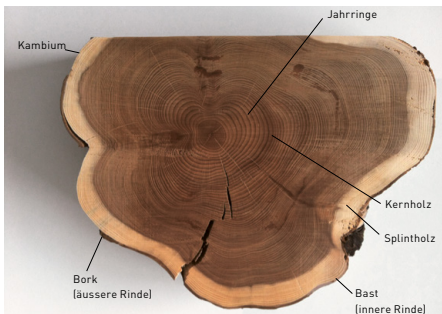
Abb. 15 | Schematischer Aufbau eines Baumstamms. Die Farbunterschiede zwischen dem Früh- und Spätholz sind bei diesem Baumstamm deutlich sichtbar. Zusammen bilden die beiden Schichten einen Jahrring. →I-09
