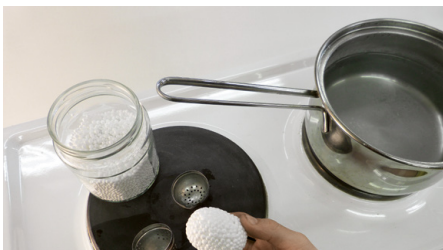
Abb. 31 | Nach einer ersten Trocknungsphase wird das vorgeschäumte Material in eine Stahl- oder Aluminiumform (hier ein Tee-Ei) gegeben. Die Form wird bis oben gefüllt und geschlossen. Nun wird über Düsen Dampf eingeblasen, der über andere Düsen wieder abgeführt wird. Durch die Hitze bläht sich das Material weiter auf. Es entsteht ein enormer Druck in der Form, und die Kügelchen verkleben zu einem grossen Block.
