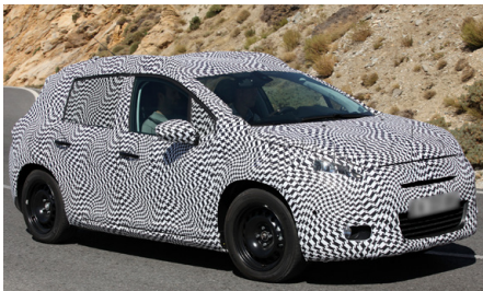
Abb. 85 | Erlkönig des Peugeot 306 aus dem Jahr 2013. Um die Form des Erlkönigs zu verschleiern, wurde das Auto komplett mit Folie abgeklebt.
