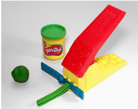
Abb. 103 | Kolbenextrusion von Knetmasse mit einem Kinderspielzeug
