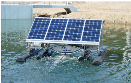
Abb. 179 | Ein bewegtes Oloid wälzt Flüssigkeiten effizient und schonend um.
