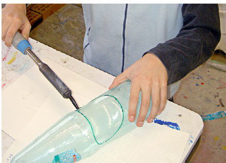
Abb. 28 | Thermoschneiden mit dem LötKolben
