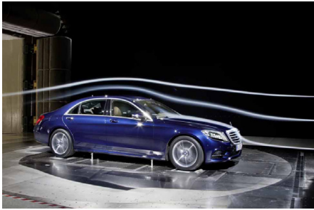
Abb. 84 | Wie Flugzeuge werden auch Autos im Windkanal getestet.
