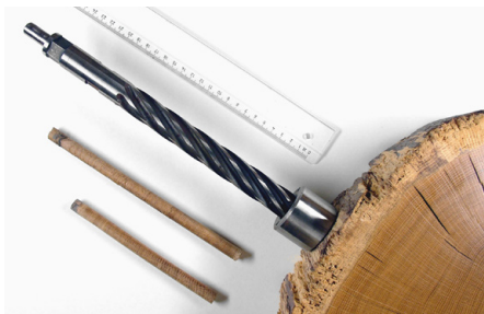
Abb. 16 | Mithilfe solcher Spezialbohrer können Proben aus dem Baumstamm entnommen werden. Alter und Wachstumsbedingungen können abgelesen werden, ohne dass der Baum gefällt werden muss.
