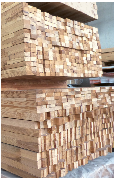
Abb. 06 | Ein Kantholz darf höchstens dreimal so breit sein, wie es dick ist.
