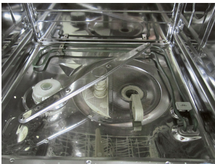
Abb. 247 | Hier wird gerade die Sprühdüse montiert.
