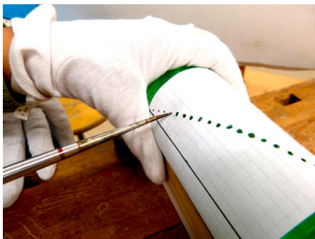
Abb. 271 | PET-Flasche mithilfe der Schablone und der erhitzten Ahle perforieren.
