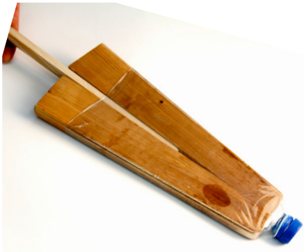
Abb. 268 | Schrumpfform mit Keil zum Spannen
