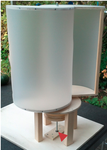
Abb. 274 | Savonius-Windrad mit Feststellschraube
