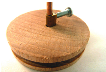
Abb. 207 | Fester Sitz auf Welle mit eingeklebtem Lüsterklemmeneinsatz
