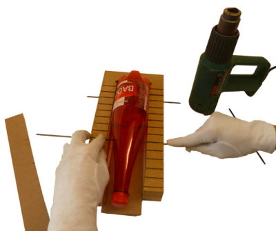
Abb. 192 | Hilfsgerät Achsmontage (Bezug www.do-it-werkstatt.ch )
