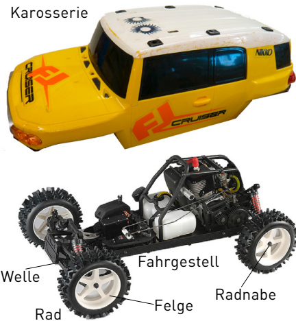
Abb. 178 | Karosserie und Fachbegriffe zum Fahrgestell
