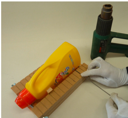
Abb. 189 | Einklemmen des unregelmässigen Behältnisses mit Keilen.
