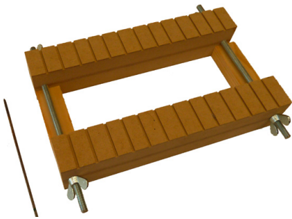
Abb. 188 | Hilfsgerät Achsmontage mit einstellbarer Breite
