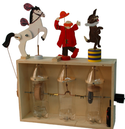
Abb. 196 | Oberstufenprojekt, mit Getriebemotorantrieb und auswechselbaren Figuren. Als Einstieg eignet sich das Video «How to Make Automata. Mechanisms & Methods» von Gery (2006, www.cabaret.co.uk ).
