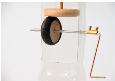
Abb. 200 | Reibrad an Kurbelwelle aus Gewindestab und Schweisstab, Kupplung mit Lüsterklemme
