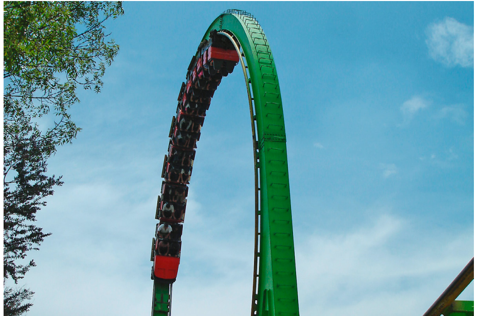
Abb. 01 | Boomerang-Achterbahn in Mexico City. Auf den Besucher wirken Geschwindigkeiten von maximal 76 km/h und Kräfte bis zu 5 g ein.
