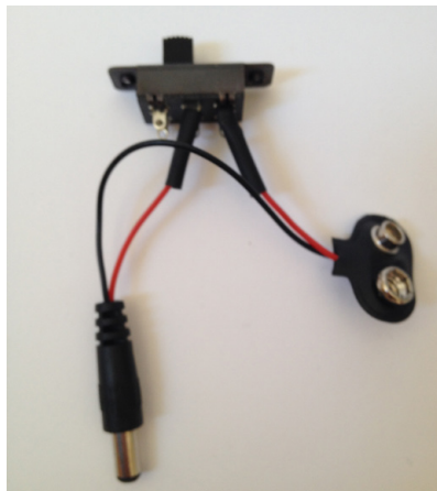
Abb. 304 | Durchgetrennter Batterieclip mit Schrumpfschlauch und Schalter.
