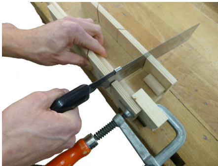
Abb. 148 | Ein Hilfsanschlag in der Gehrungsschneidelade führt beim Serienschritt zu gleich langen Holzteilen.
