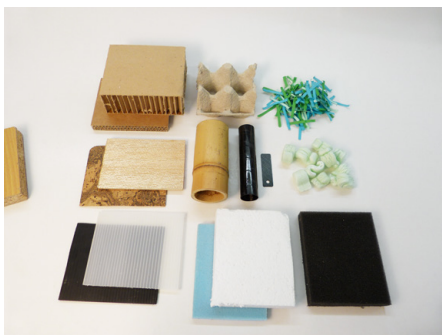
Abb. 181 | Diverse Leichtbaumaterialien aus dem Fachraum Technisches Gestalten
