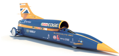
Abb. 88 | Der Bloodhound SSC soll mit seinem Raketenantrieb über 1000 mph (1609 km/h) erreichen.
