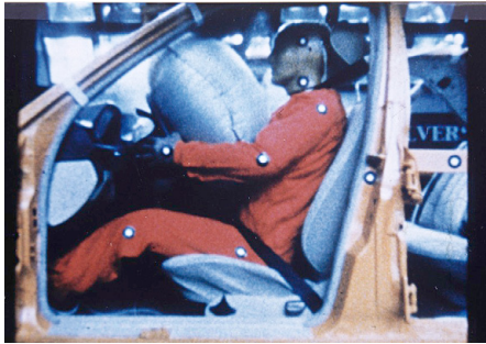
Abb. 91 | Bei einem Aufprall lösen Sensoren den Airbag aus, der sich innerhalb von Millisekunden aufbläst.
