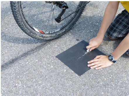
Abb. 18 | Testet den Gummiverbrauch eines Reifens. Ein Radiergummi auf einem Schleifpapier verliert bei raschem Darüberfahren viele Gummikrümel. So ist es auch beim Fahrrad- oder Autoreifen: Bremsst man scharf, sodass die Reifen quietschen, sieht man anschliessend schwarze Bremsstreifen auf der Strasse.
