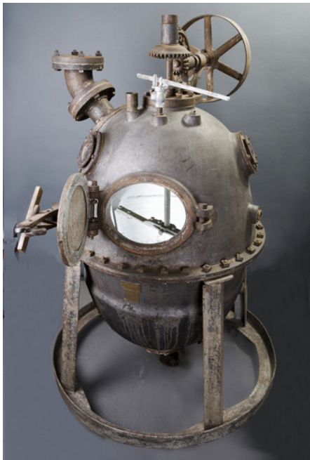
Abb. 19 | Mithilfe des Bakelizers gelang Baekeland die Herstellung des ersten vollständig synthetischen Materials – des Bakelits.
